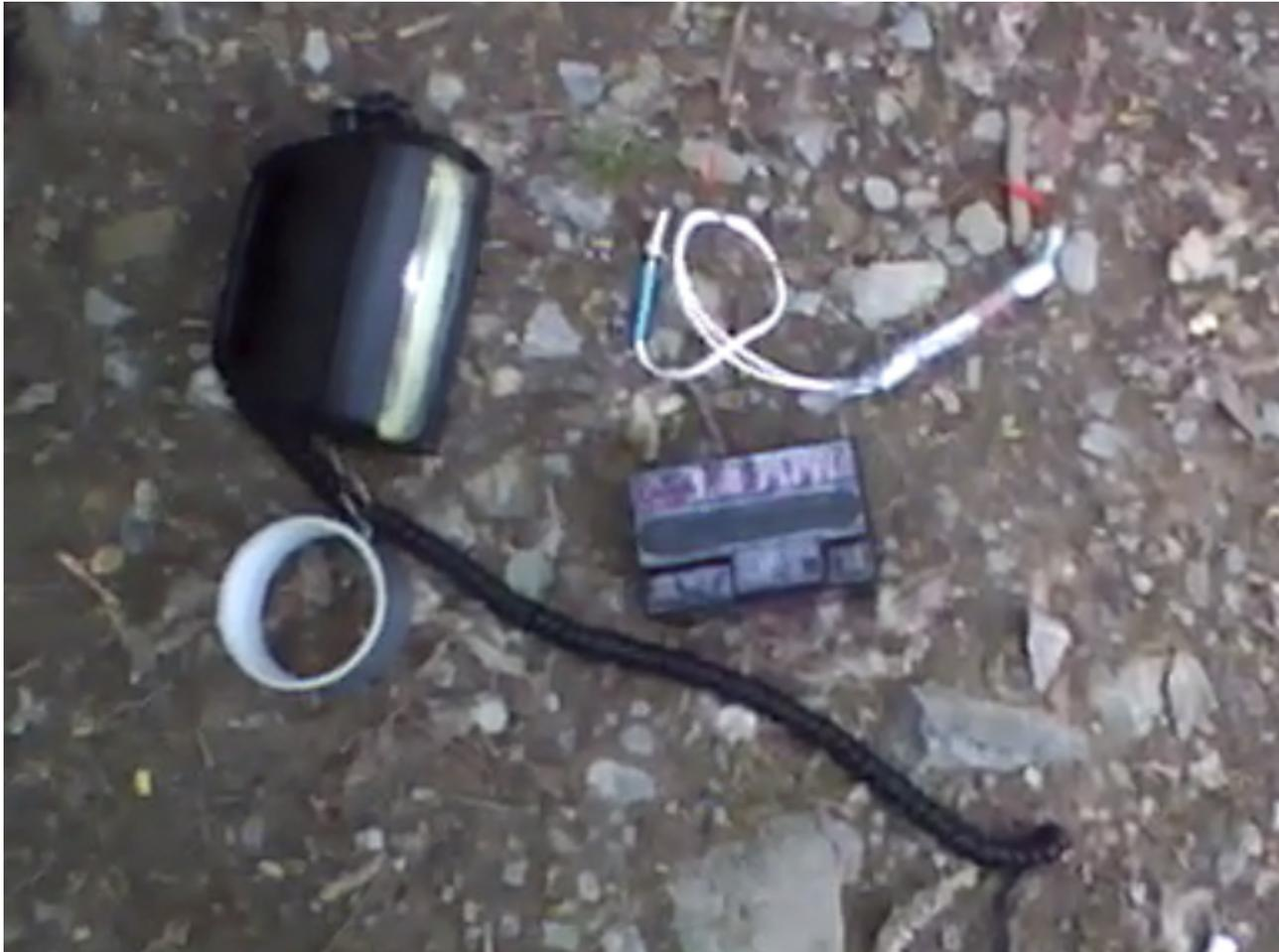
Lampe, bestehend aus einem Handscheinwerfer, betrieben mit einer Rollerbatterie. Alles wurde mit Kabeln verbunden und festgeklebt, die Batterie wurde in der Bauchtasche transportiert.
